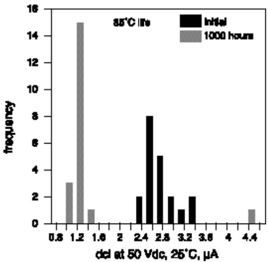
Fig. 7. 85°C life dc leakage
